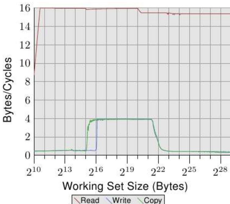
图3.27: Core 2运行双线程时的带宽表现
